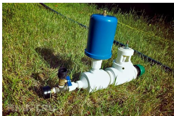
1-питающая трубка, 2-отбойный клапан, 3-возвратный клапан, 4-воздушный клапан, 5-отводящая труба
