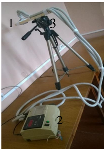
Рисунок 1.2 – Стенд для облучения листьев и корней рассады капусты белокочанной.
