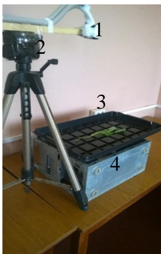
Рисунок 1.3 – Стенд для облучения листьев и корней рассады капусты белокочанной.
