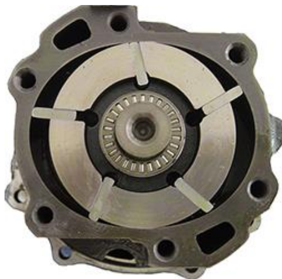
Рисунок 9 - Пластинчатый гидронасос двойного действия [13].
