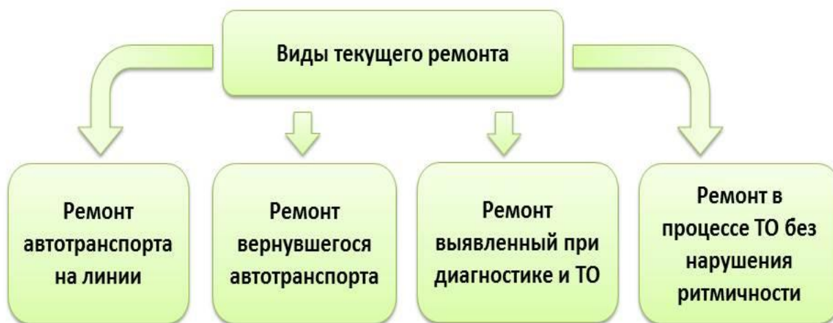
Рисунок 1 – Виды текущего ремонта.
