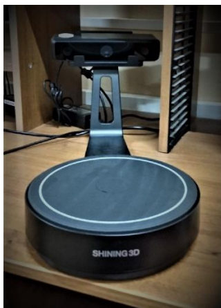
Рисунок 3 - 3D-сканер Shining 3D Einscan SE в помещении лаборатории.
