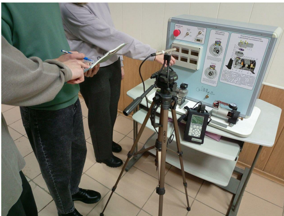
Рисунок 2 - Шумомер с микрофоном установленный в лаборатории.
