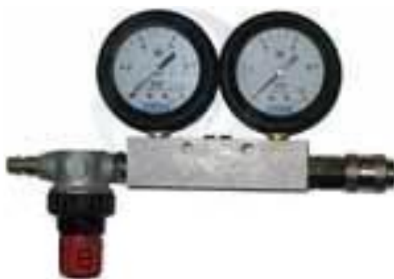
Рисунок 3 - Пневмотестер для проверки цилиндропоршневой группы SMC-111.
