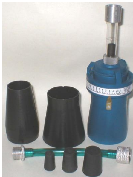
Рисунок 2 – Расходомер картерных газов КИ-17999М.
