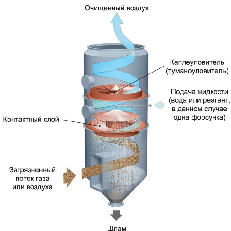
Рисунок 3 – Принцип работы скруббера.
