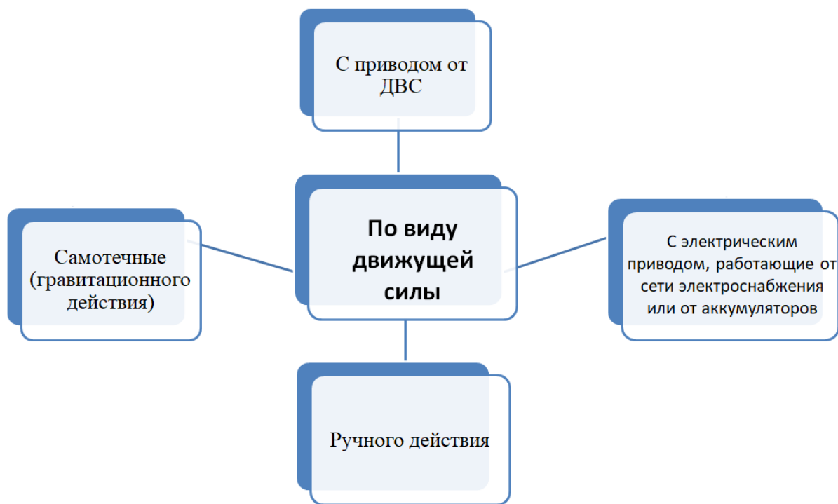
Рисунок 1 - Классификация подъемно-транспортного оборудования по виду.
