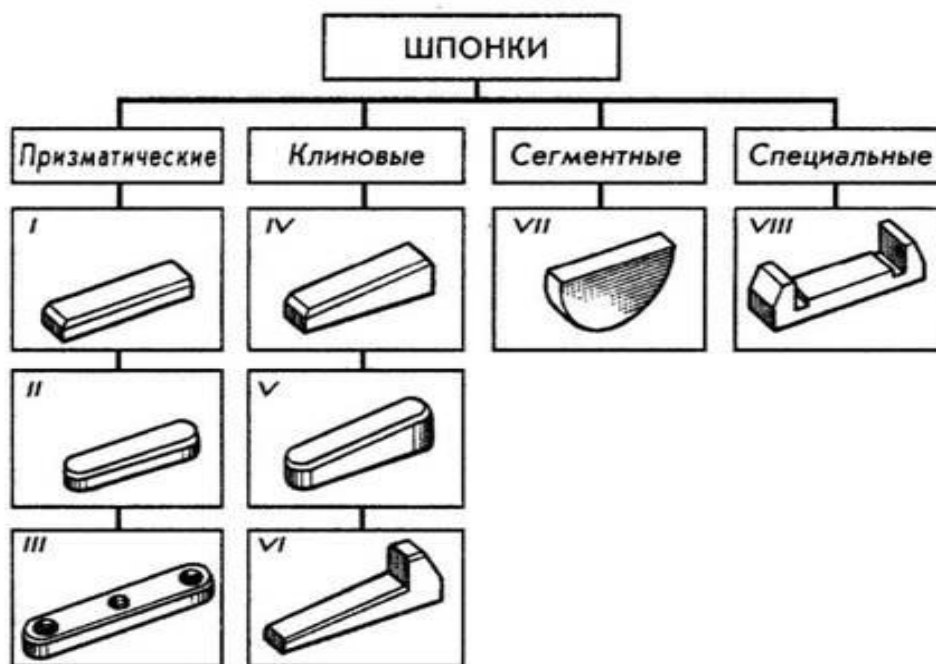
Рисунок 2 – Классификация шпонок по форме.
