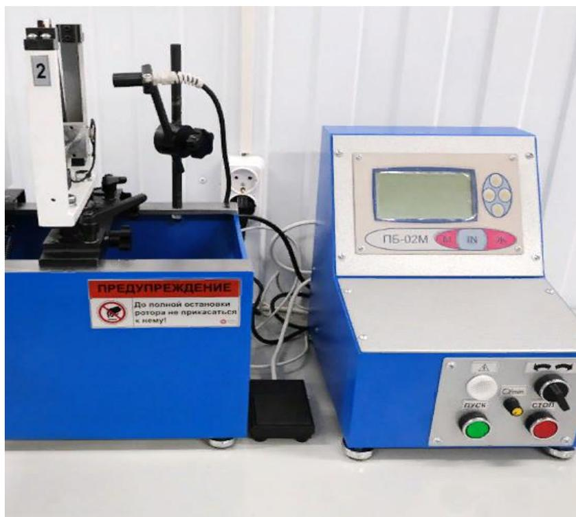
Рисунок 4 - Балансировочный станок модели (БВИ-03-10Т).
