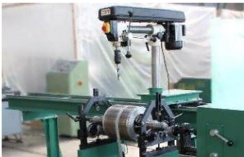
*Рисунок 3 - Станок (9Д715УС) для балансировки коленчатых валов и роторов массой до 300 кг.*
