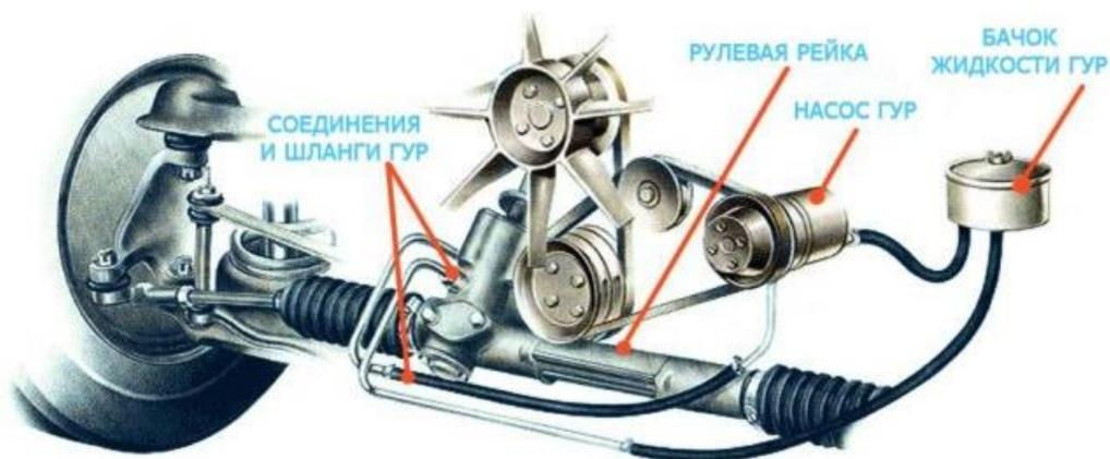
Рисунок 2 - Схема гидроусилителя руля.
