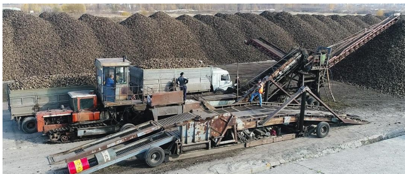
Рисунок 3 – Буртоукладочная машина (Ш1-П) при формировании кагата корнеплодов.
