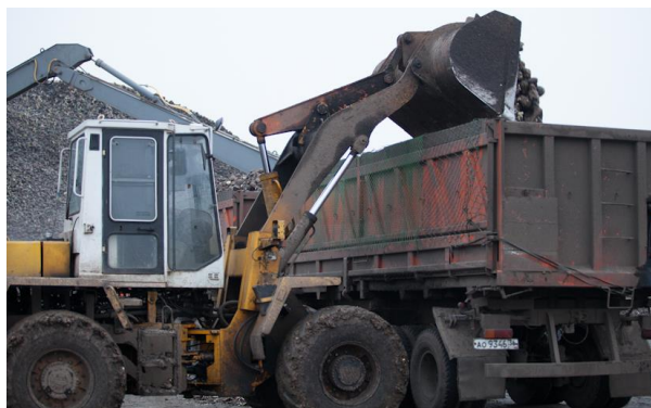
Рисунок 4 – Разборка кагата и перегрузка корнеплодов в технологический транспорт для перемещения на переработку.
