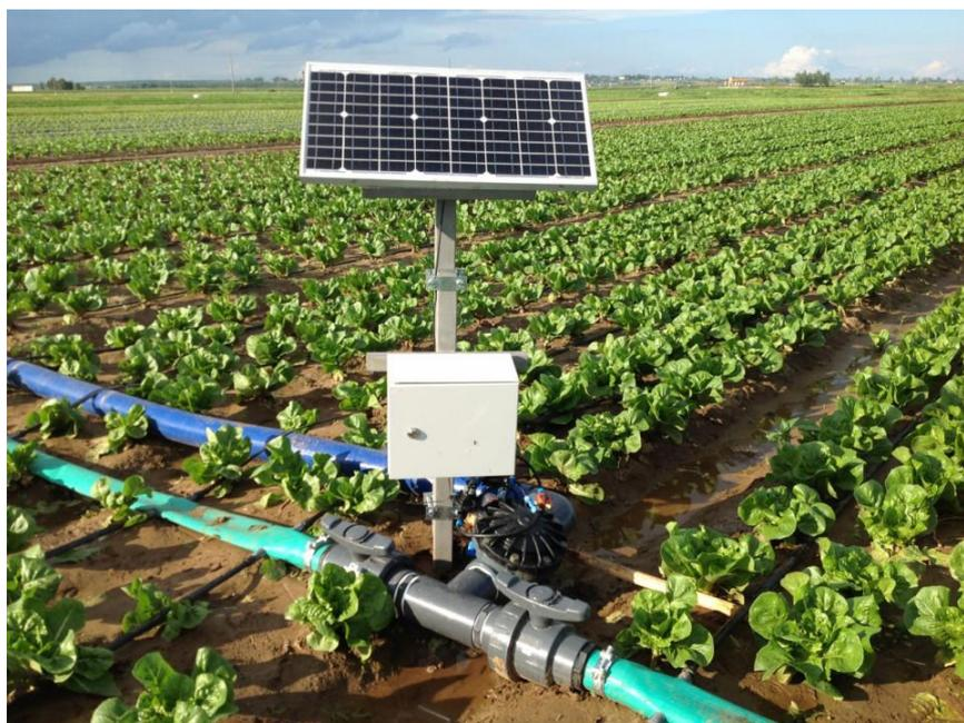
Рисунок 3 - Фото системы капельного орошения почвы.
