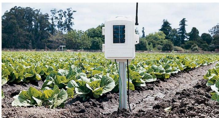
*Рисунок 1 - Фото датчика влажности почвы.*
