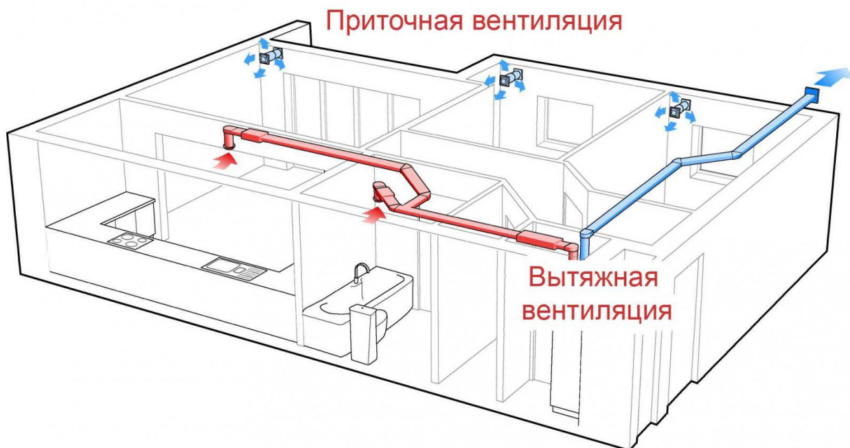
Рисунок 2 – Система приточно-вытяжной вентиляции.
