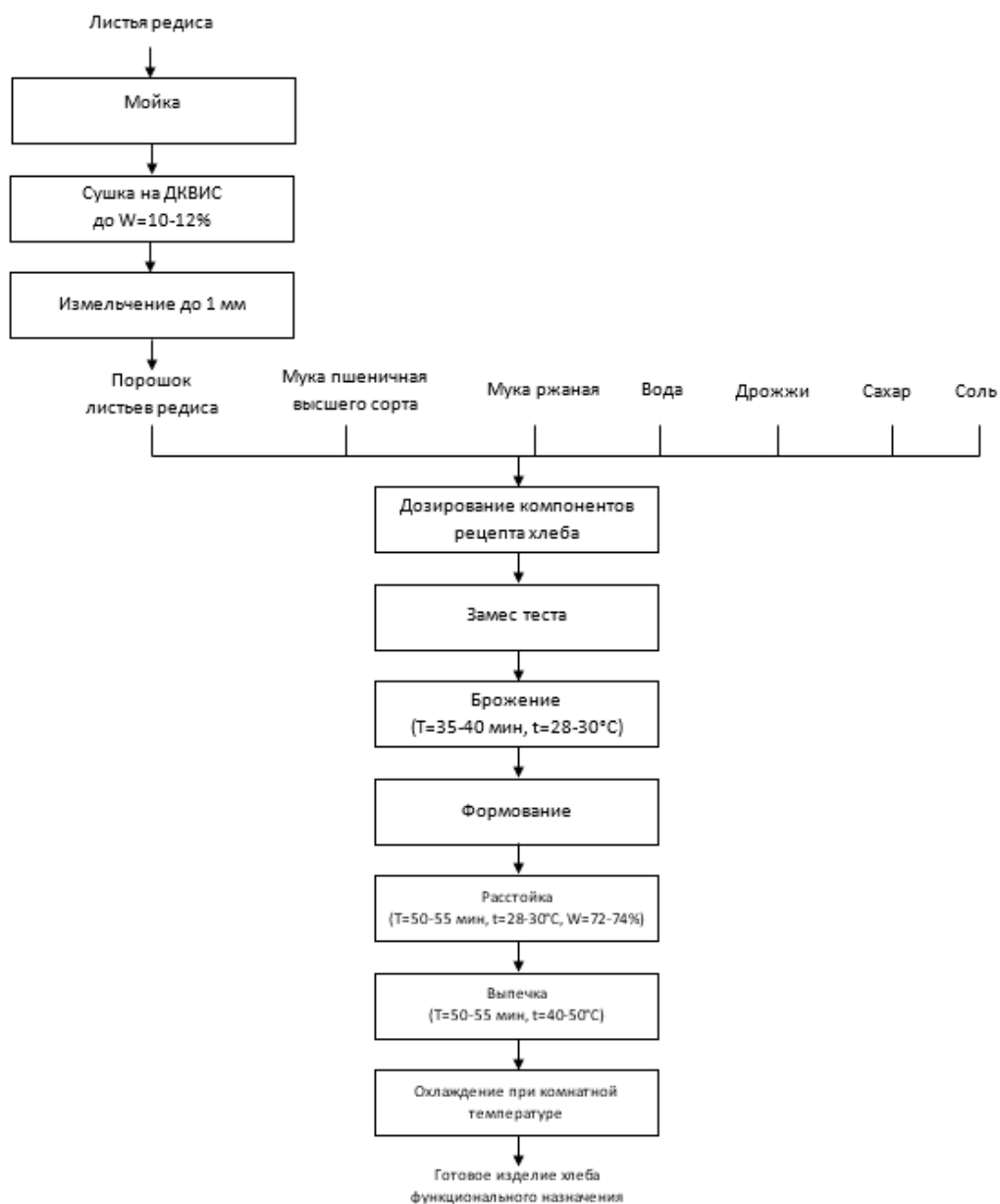
Рисунок 2 – Эскизная технологическая схема производства хлеба функционального назначения с использованием порошка листьев редиса
