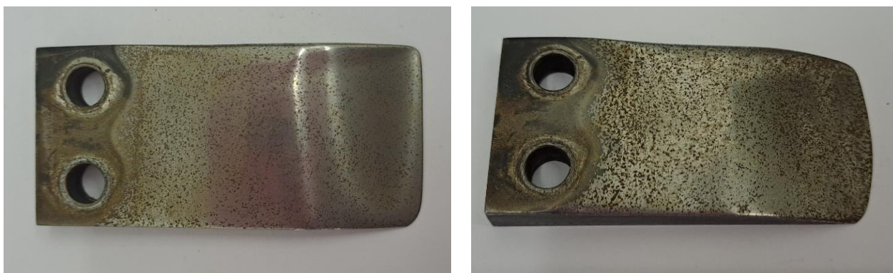
Рисунок 1 – Линейный износ стали 0,43C-1,60Si-0,01Mn-1,1Cr-0,95Mo-0,08V-0,05Nb-0,04Ti после: а) 80 часов б) 160 часов
