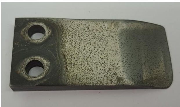
Рисунок 2 – Линейный износ стали 65Г после: а) 80 часов б) 160 часов
