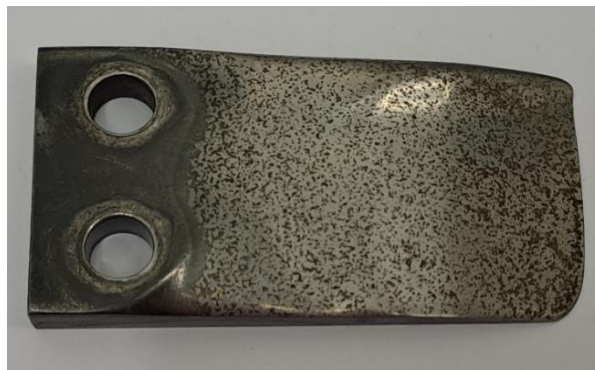
Рисунок 2 – Линейный износ стали 65Г после: а) 80 часов б) 160 часов
