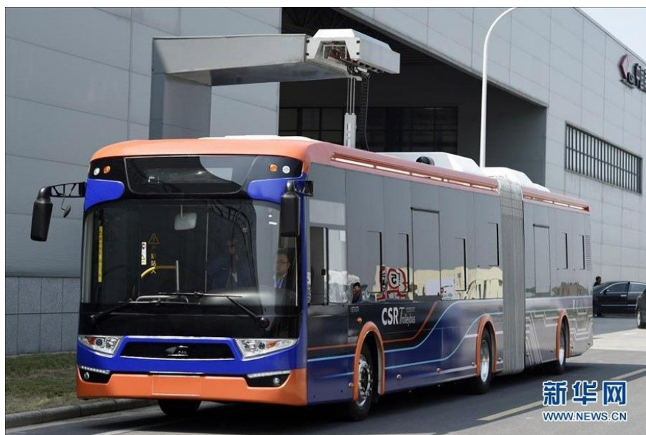
Рисунок 2 – Зарядка электробуса на остановке [1]
