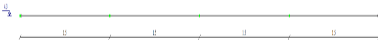
Рисунок 2 - Шарнирная балка, длиной 6 метров, поделена на 4 участка, длиной 1,5 метра
