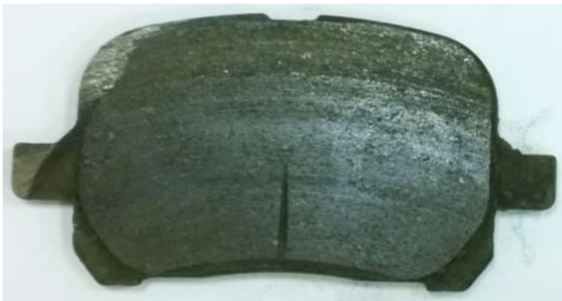
Рисунок 2 - Неравномерный износ фрикционной накладки на разных полюсах колодки. Толщины на одном полюсе - 0 мм, на противоположном - 2мм. Износ фрикционной накладки до металла [1]
