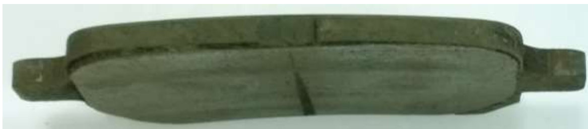
Рисунок 1 - Неравномерный износ фрикционной накладки на разных полюсах колодки [1]
