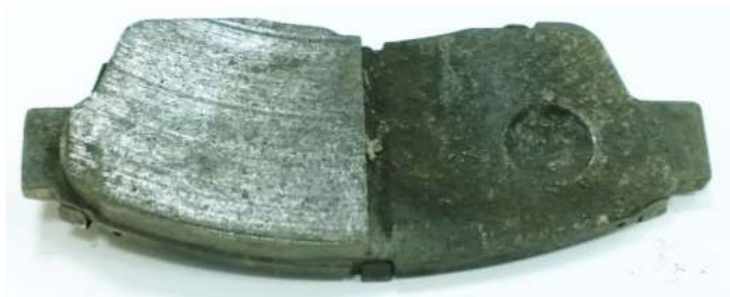
Рисунок 3 - Скол половины фрикционной накладки тормозной колодки [1]
