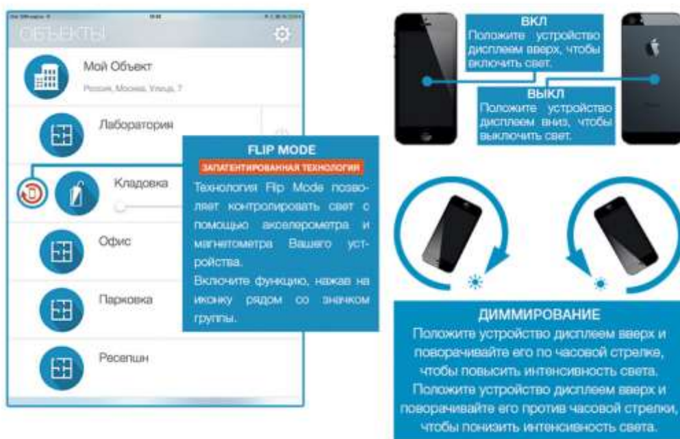
Рисунок 4 - Облачная система управления освещением: Flip Mode режим
