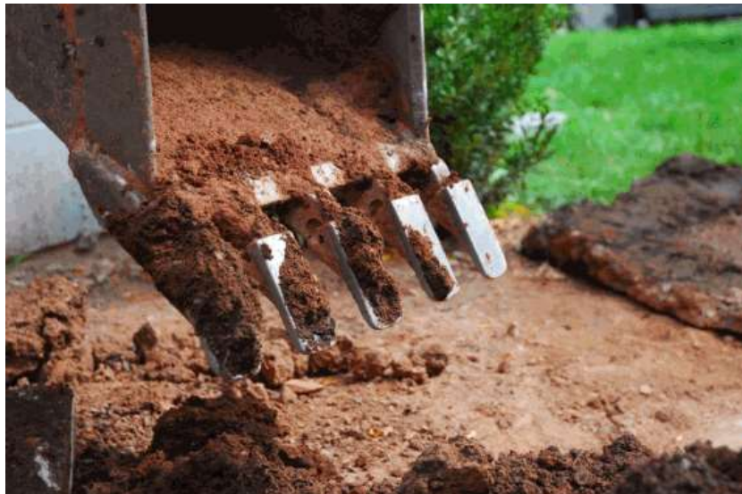
Рисунок 1 – Налипший слой земли на примере рабочего ковша отечественного экскаватора ЭКГ-5,8
