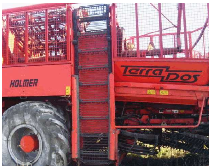
Рисунок 7 – Бункер-накопитель корнеплодов сахарной свеклы и транспортер для выгрузки бункера накопителя комбайна Terra Dos немецкого производителя Holmer
