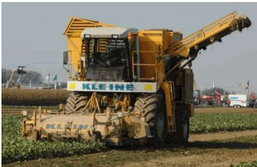
Рисунок 3 – Комбайн для уборки корнеплодов сахарной свеклы SF 12–5 от французского производителя «Franz Kleine»
