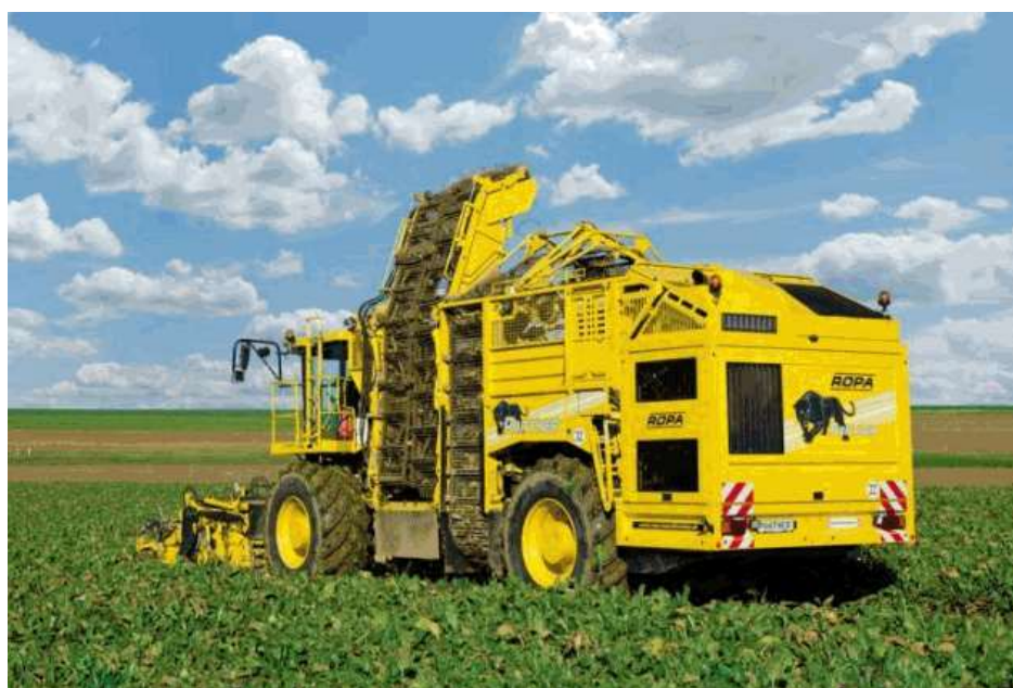
Рисунок 2 – Уборка урожая корнеплодов сахарной свеклы самоходным свеклоборочным комбайном фирмы «Рора»
