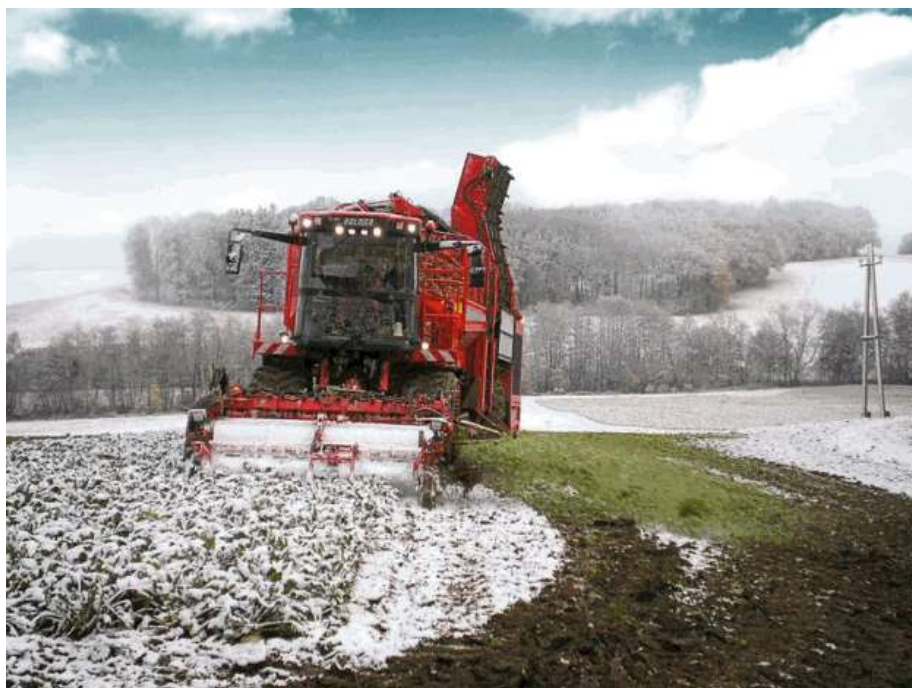
Рисунок 1 – Уборка урожая корнеплодов сахарной свеклы самоходным свеклоборочным комбайном фирмы Holmer
