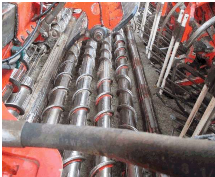
Рисунок 6 – Сепарирующие валы с винтовой нарезкой комбайна для уборки корнеплодов сахарной свеклы «Terra Dos T4»
