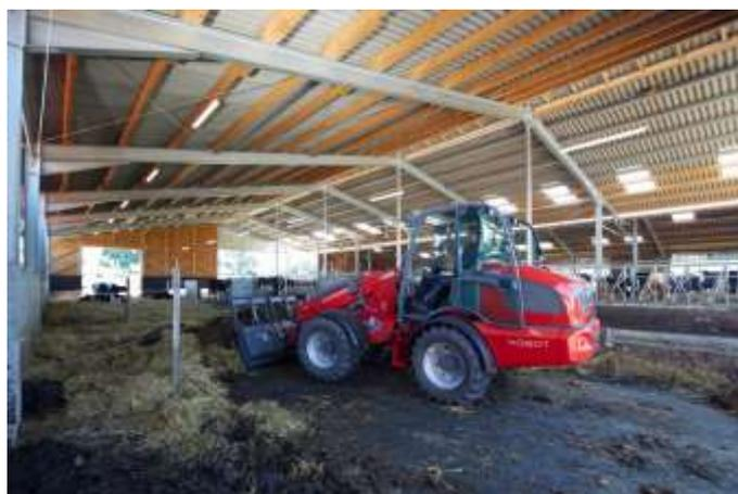
Рисунок 5 – Трактор со скребком: 1 – тело волочения (соломонавозная смесь); 2 – скребок; 3 – трактор
