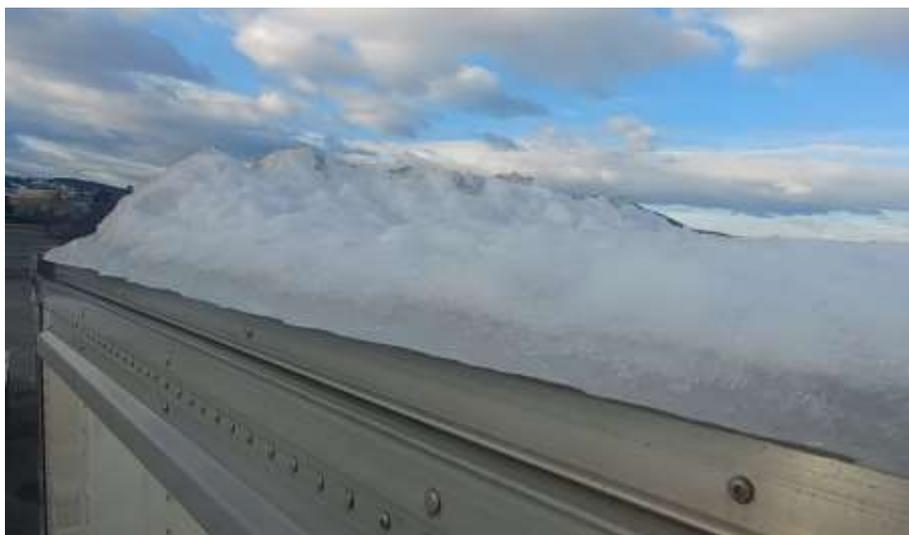
*Рисунок 1* – Нанесение снега на крыше полуприцепа
