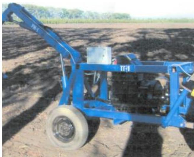
Рисунок 2 – Экспериментальный образец агрегата для технического обслуживания без шкафов для хранения инструмента
