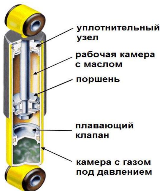
Рисунок 2 - Устройство однотрубного амортизатора
