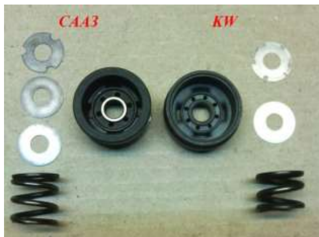
Рисунок 3 - Поршень и клапанная группа для усилий отбоя
