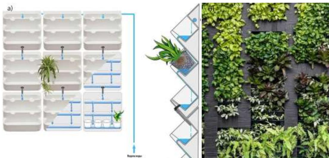
Рисунок 4 – Схема (а) и пример контейнерной системы вертикального озеленения
