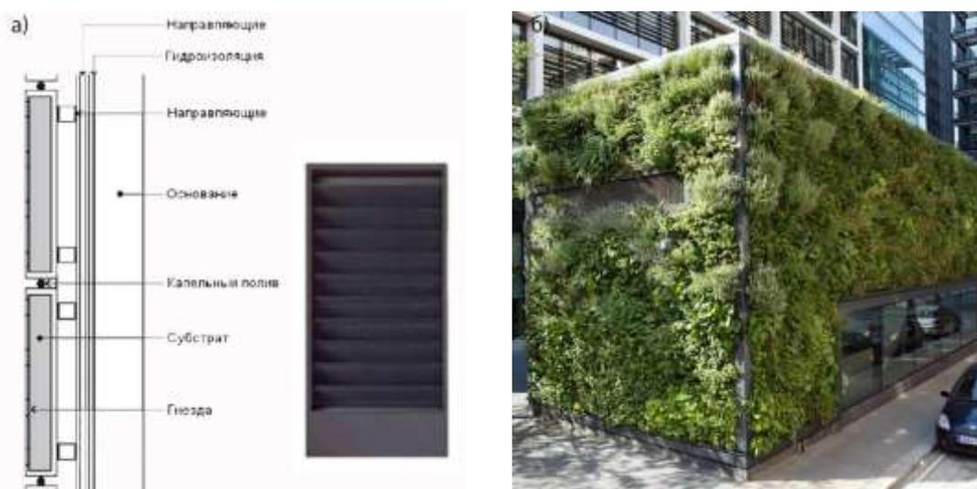
Рисунок 3 – Схема (а) и пример (б) модульной системы вертикального озеленения
