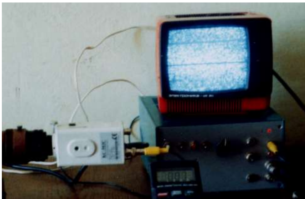
Рисунок 1. Внешний вид устройства синхронного ввода видео и внешнего аналогового сигнала в ЭВМ. На экране монитора хорошо заметны две узкие темные горизонтальные полосы, замещающие видеосигнал на внешнюю аналоговую информацию.
