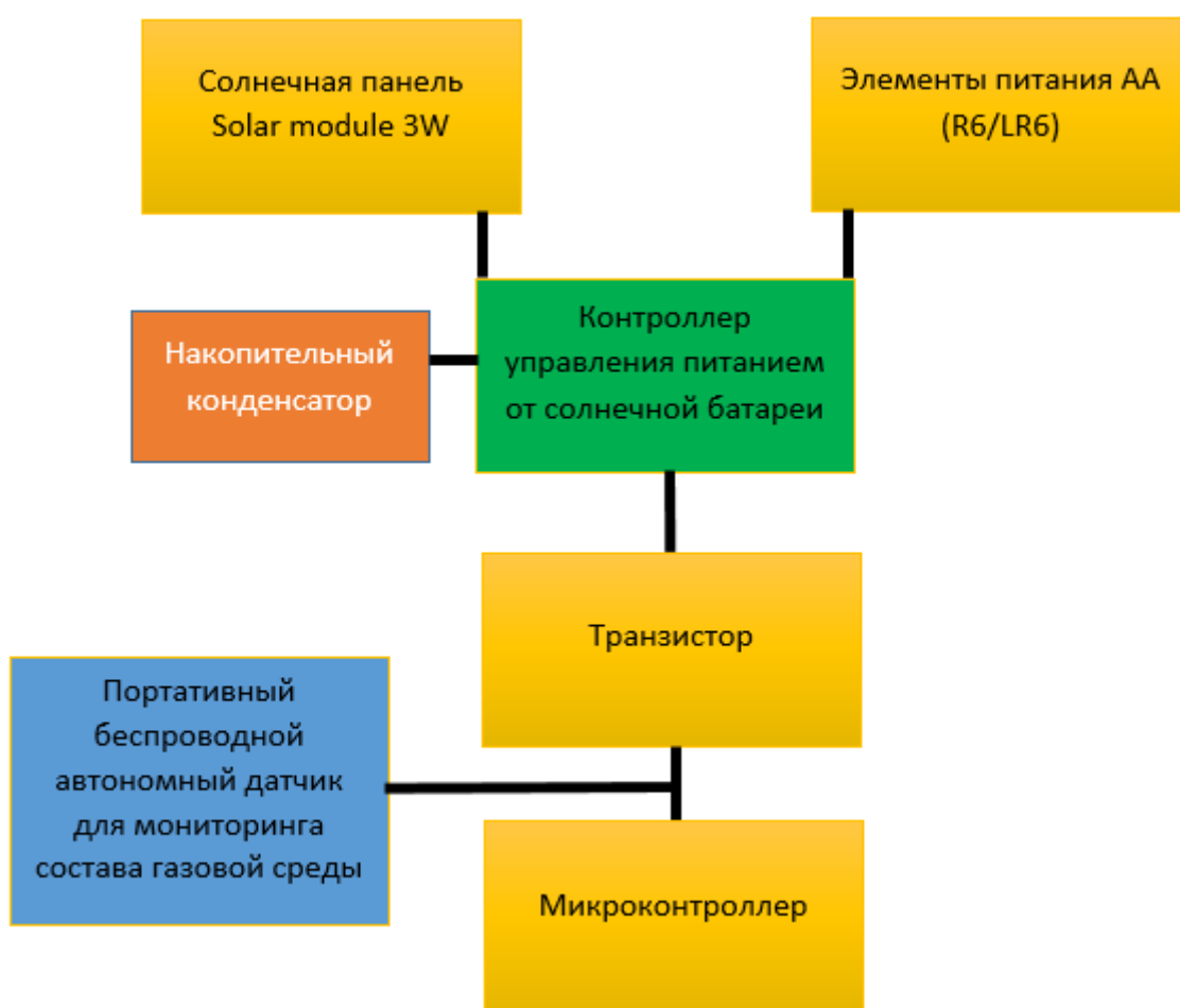
Рисунок 2 – Схема для подключения и автономной работы портативного беспроводного автономного датчика для мониторинга состава газовой среды
