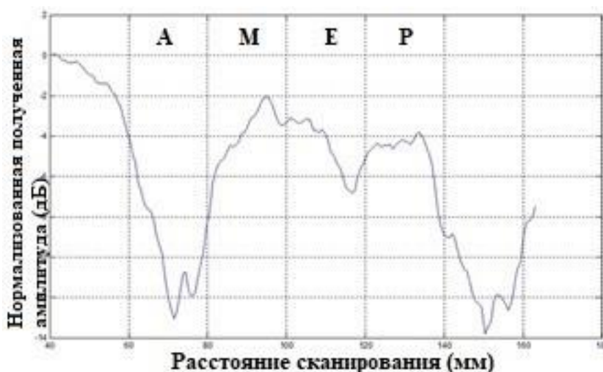
Рис. 7. Линейное сканирование вдоль двух тефлоновых вставок, ламинат с 24 слоями, измеренный после длительного уплотнения.
