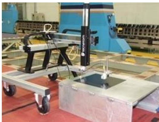
Рис. 5. Изображение алюминиевой формы с углепластиком, преобразователями и системой сканирования.
