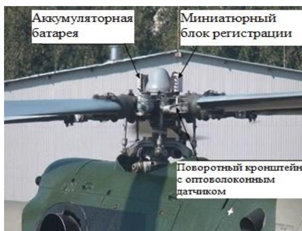
Рис. 7. Установленные на вертолете элементы системы контроля технического состояния вращающихся элементов лопасти несущего винта.
