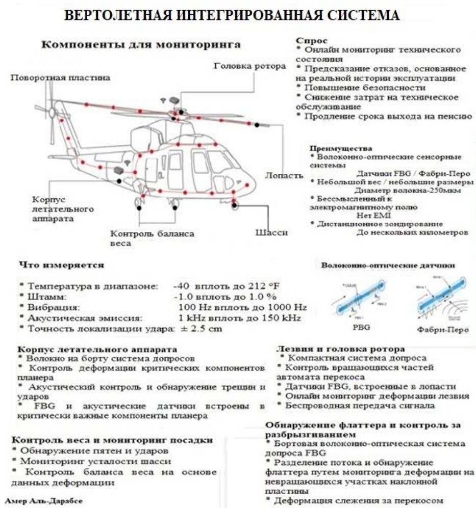
Рис. 2. Интегрированная система контроля технического состояния высокочувствительных вертолетных установок на основе волоконно-оптической технологии
