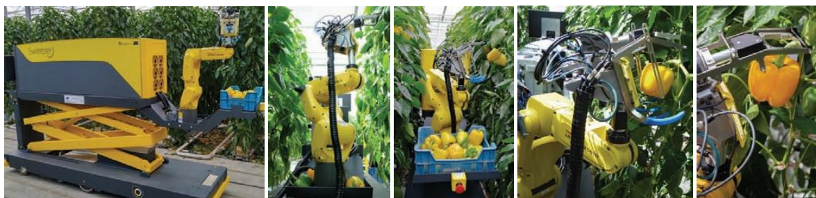
Рисунок 1 – Робот SWEEPER в действии: первая в мире полностью автоматизированная платформа для сбора сладкого перца
