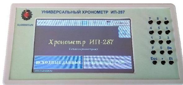
Рисунок 1 – Общий вид прибора «Универсальный хронометр ИП-287»
