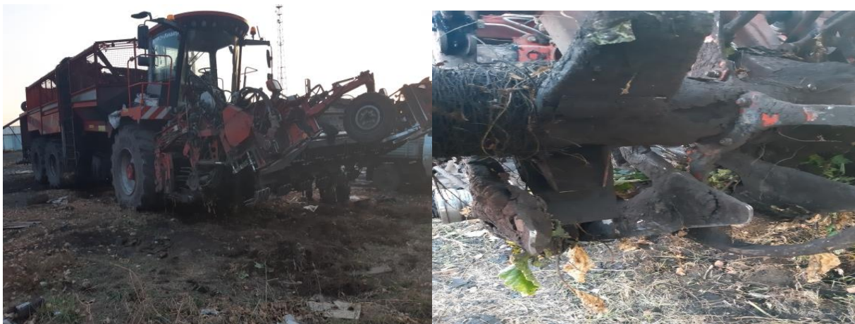
Рисунок 2 – Свеклоуборочный комбайн HOLMER T4-40 и его выкапывающие рабочие органы
