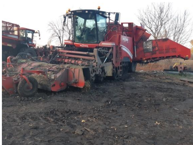
Рисунок 1 – Свеклоуборочный комбайн Grimme Maxtron II 620 и его рабочие органы для выкопки корнеплодов
