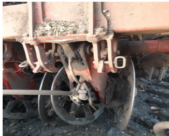
Рисунок 1 – Свеклоуборочный комбайн Grimme Maxtron II 620 и его рабочие органы для выкопки корнеплодов
