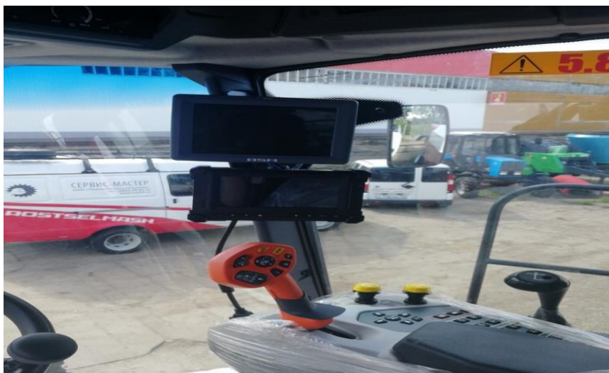
Рисунок 2 – Дисплей оператора для контроля и настройки системы
