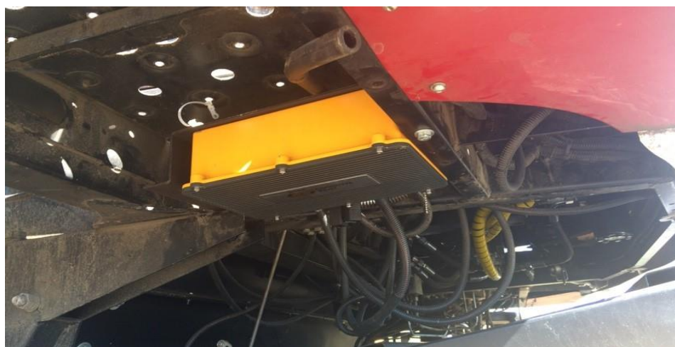
Рисунок 3 – Системный блок управления NVIDIA TX2/
