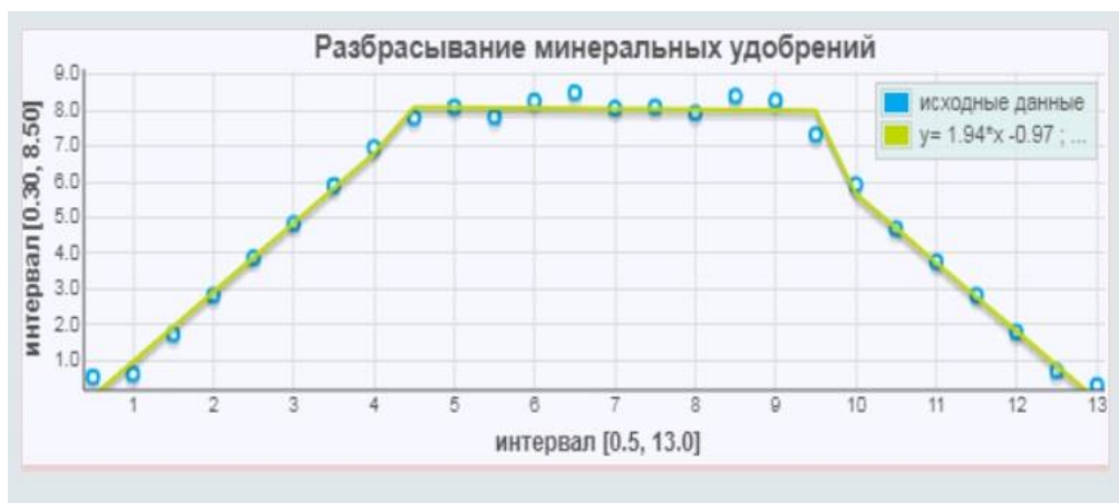
Рисунок 1 – График распределения массы разброса минеральных удобрений по ширине
