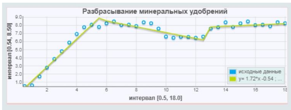
Рисунок 2 – График распределения массы разброса минеральных удобрений по ширине при двух проходах
