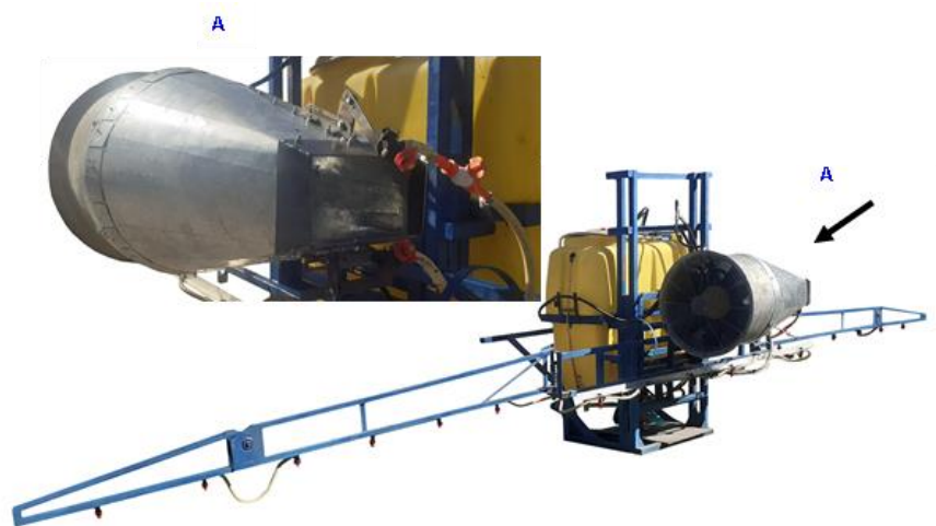
Рисунок 2 – Общий вид штанги с комплектом специального оборудования для аэрозольной обработки краевых участков полей и защитных лесополос растворами инсектицидов и гербицидов при защите от вредителей и уничтожении сорняков
