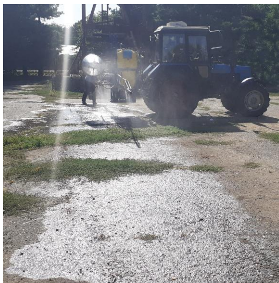
Рисунок 4 – Процесс осаждения капельной жидкости за пределы края штанги навесного опрыскивателя при распространении воздушно - капельной системы, создаваемой щелевыми распылителями и воздушным потоком от вентилятора с коническим соплом.
