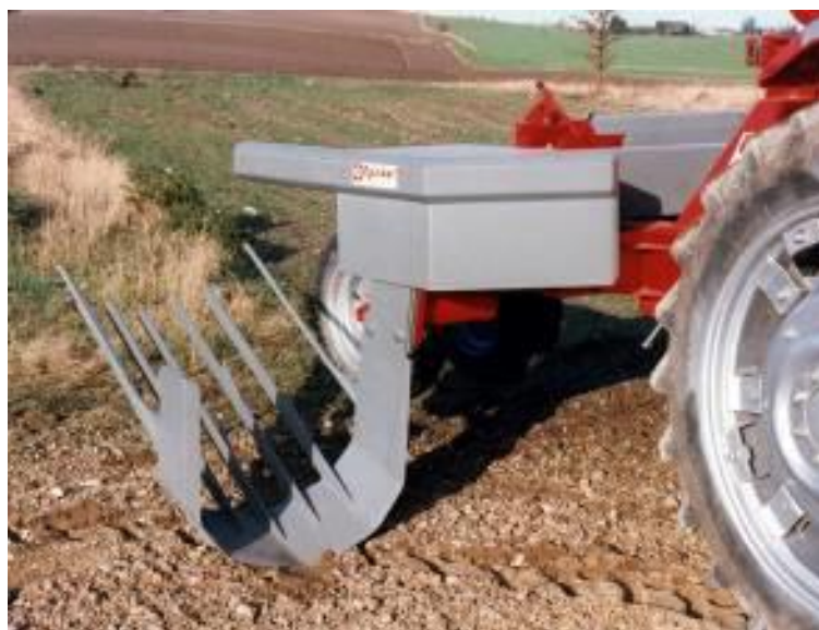
Рисунок 3 - Асимметричный выкопчный плуг типа Wibro
