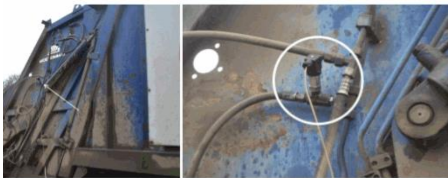
Рисунок 3 – Место установки датчика давления
