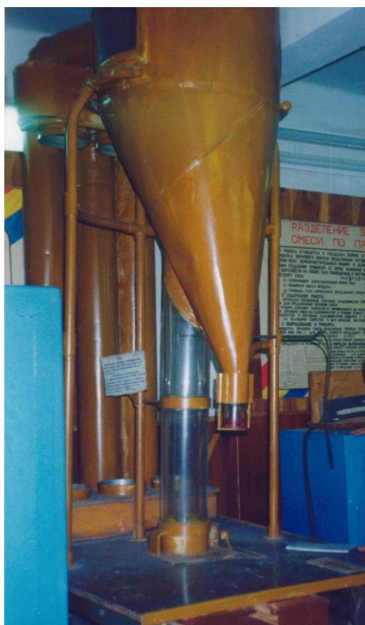
Рисунок 2 - Парусный классификатор, Электронные весы ВЛК – 500; Сушильный шкаф СВШ – 3м
