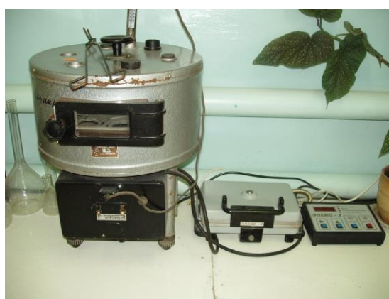
Рисунок 2 - Парусный классификатор, Электронные весы ВЛК – 500; Сушильный шкаф СВШ – 3м
