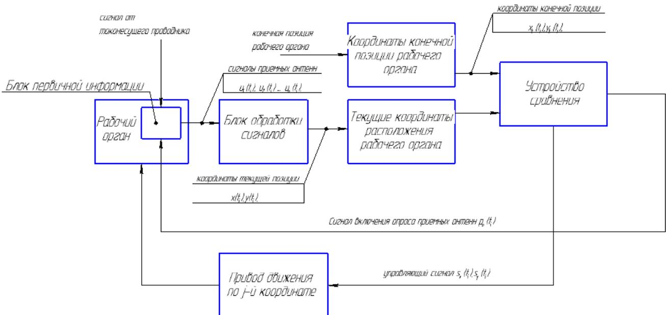
где  $u_1(t), u_2(t), \dots, u_n(t)$ ,  $n = 1 \dots 6$  – сигналы приемных магнитных антенн;  $x(t), y(t)$  – текущие координаты расположения рабочего органа;  $x_k(t), y_k(t)$  – конечные координаты позиции рабочего органа;  $p_a(t)$  – сигнал включения опроса приемных антенн в блоке первичной информации;  $s_x(t), s_y(t)$  – управляющие сигналы для приводов движения по координатам соответственно X и Y
