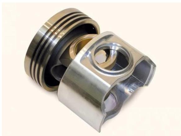
*Рисунок 3 - Составной поршень*
