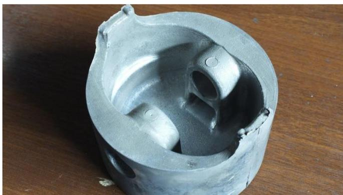
*Рисунок 2 - Кокильная отливка чугунного поршня*
