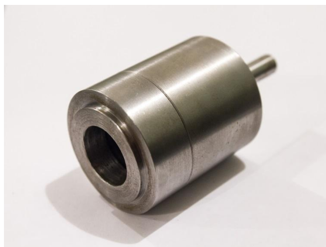
Рисунок 2 – Общий вид оснастки для исследования усилия резания покрытий эластомера Ф-40С
