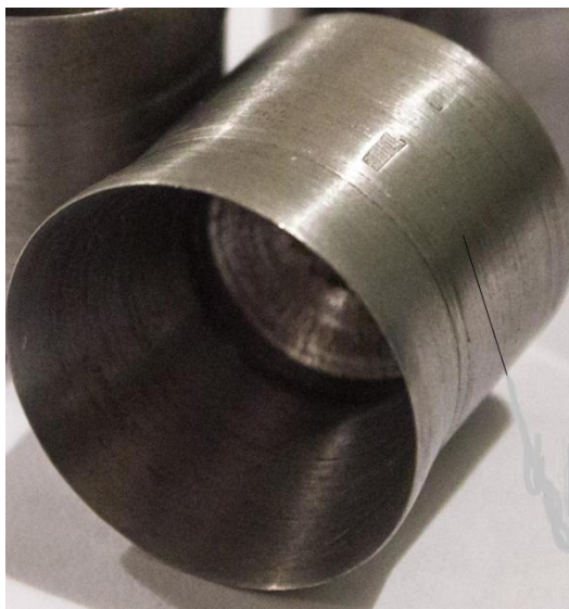
Рисунок 3 – Калибр-резец для исследования усилия резания покрытия эластомера Ф-40С
