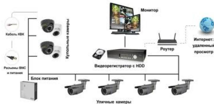
Рисунок 2 – Типовая схема системы охранного телевидения
