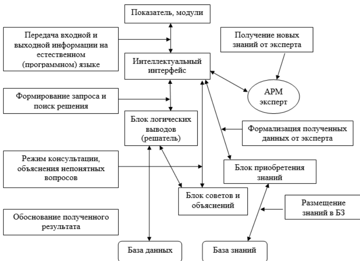
Рисунок 1. Функциональная схема компьютерной интеллектуальной системы технического учета топливно-энергетических ресурсов в ООО «Центральное» Никифоровского района Тамбовской области [5, 6, 7].
