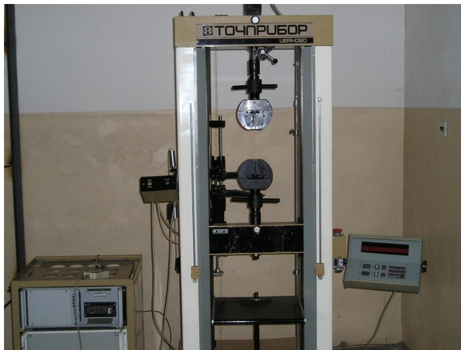
Рисунок 3 – Разрывная машина ИР 5047-50
