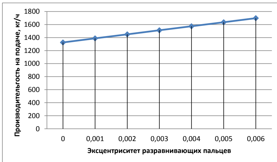
Рисунок 6 – Зависимость производительности ленточного транспортера при подаче на разравнивание в зависимости от смещения (эксцентриситета) вала a
