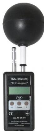
Рисунок 1 - Термогигрометр ТКА-ПКМ(24)
