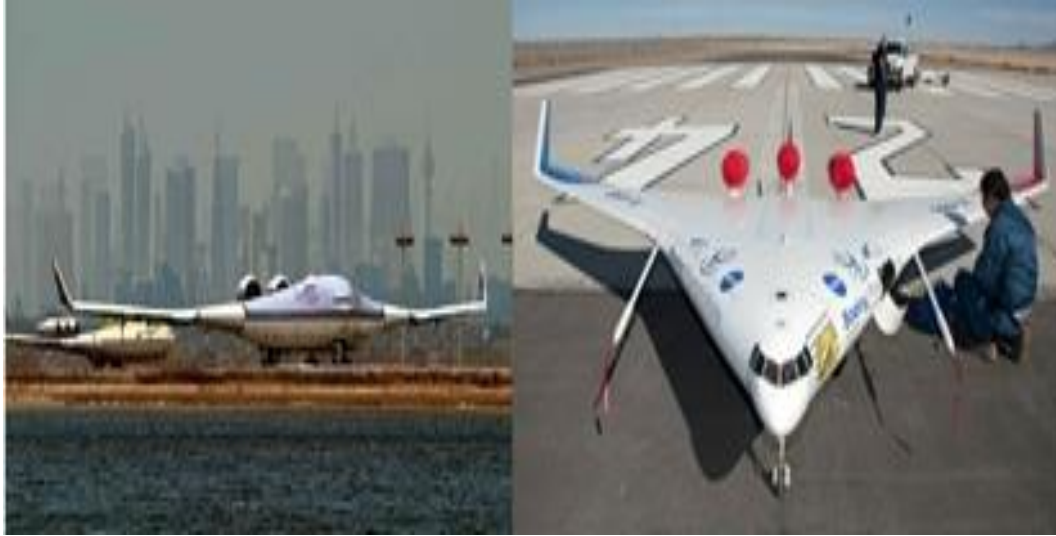
Рис. 3. Принцип работы смешанное тело крыла (слева) и прототип Boeing X48C BWB (справа)
