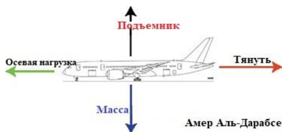
Рис. 1. Силы, действующие на плоскости по диаграмме свободного тела
